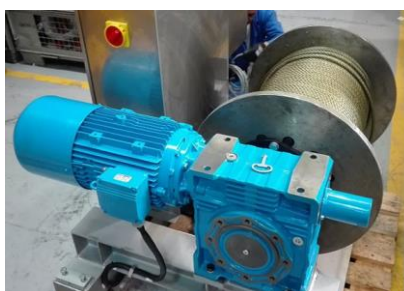
شکل ۲۸: نمونه ای از سیم بکسل های مورد استفاده در هویست
