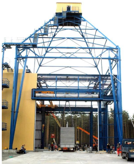
شکل ۱۰: آزمایش بالاتر از ظرفیت مجموعه به وزن ۲۵۰ تن
