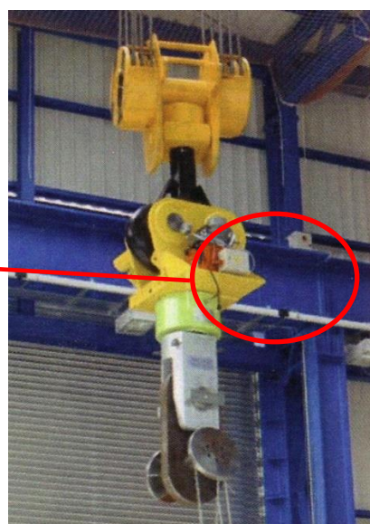
شکل ۳۶: مکانیزم رهایش الکترومکانیک مورد استفاده در آزمایشگاه BAM
