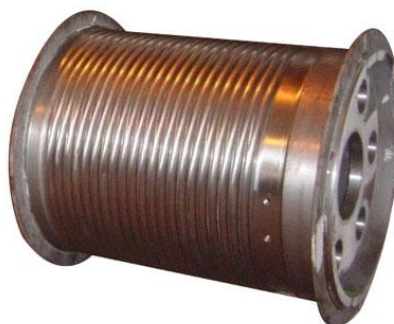
شکل ۲۷: نمونه ای از درام مورد استفاده در هویست
