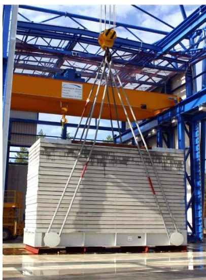
شکل ۷: جرثقیل دروازه ای ۸۰ تنی سالن تست
