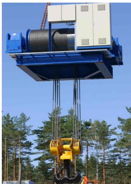
شکل ۳۲: هویست ۲۰۰ تن مورد استفاده در آزمایشگاه BAM
