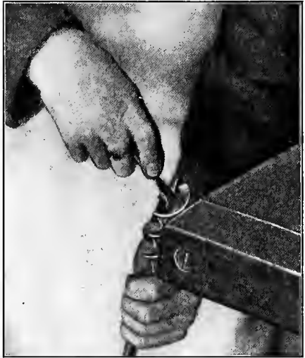
FIG. 69. — FILING AN AUGER BIT.
