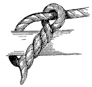
Fig. 38.—Timber hitch.
