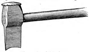
FIG. III. -- THE GOUGE CHISEL.
