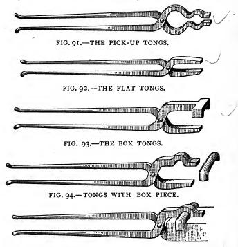
FIG. 95.—SHOWING HOW THE TONGS AND BOX PIECES ARE USED.
