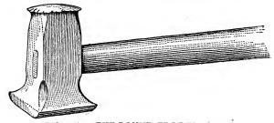
FIG. 127.--THE ROUND-EDGE FLATTER.
