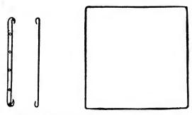
FIG. 45.—IRONS BY WHICH THE FRAME IS FASTENED TO THE BENCH.
