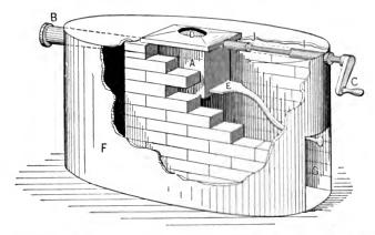
FIG. 49.-SHOWS POSITION "J. T. B.'S" TUYERE ON THE FORGE.
