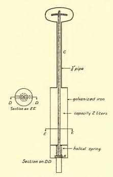
FIG. 7.-SEWAGE SAMPLING DEVICE
