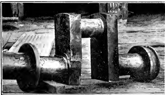
FIG. 5. BROKEN CRANK WEB.
