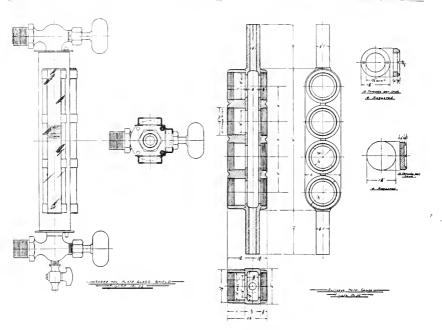
FIG. 13.— PLATE GLASS SHIELD.
