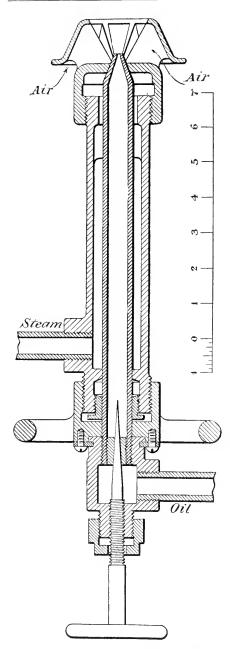
FIG. 5. — THE OIL CITY BOILER WORKS STEAM BURNER.
