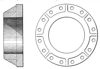
FIGS. 3 AND 4.— DESIGN FOR A CAST-IRON FITTING FOR A TEN-INCH STEAM PIPE.
