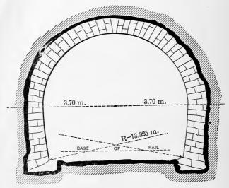
Fig. 89. -St. CLOUD TUNNEL.
