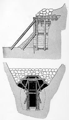
Fig. 96.—Timbering for Tunnel Portal.
