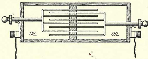
Fig. 30. Adjustable Condenser
