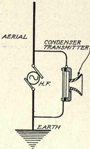
Fig. 12. Condenser Transmitter
