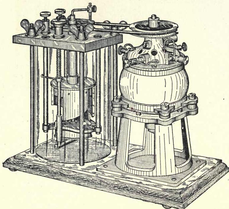
Fig. 26. Mercury Turbine Interrupter
