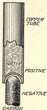
Fig. 15. Telefunken Electrodes
