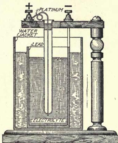
Fig. 27. Wehnelt Interrupter
