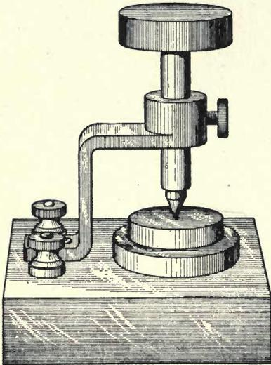
Fig. 45. Silicon Detector
