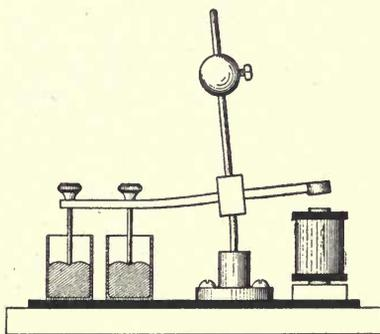
Fig. 25. Foucault Mercury Break
