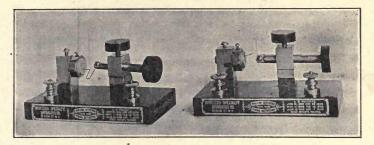
Fig. 163. Pyron Detector.
