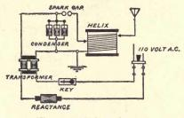
Fig. 50. Wiring Diagram.
