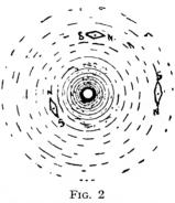
MAGNETIC LINES ROUND CONDUCTOR OF ELECTRIC CURRENT
