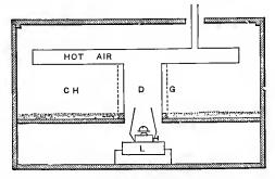
Fig. 58 .- Hot Radiating Chamber.
