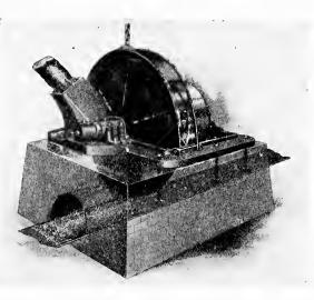
FIG. 21. PULP WOOD CHIPPER
