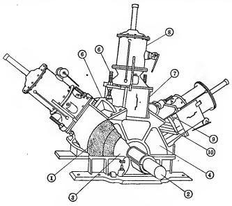
FIG. 31. THREE-POCKET GRINDER
