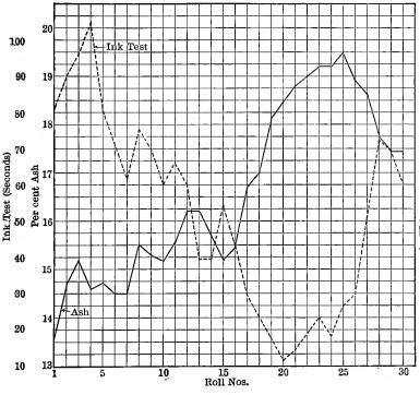
FIG. 36. EFFECT OF FILLER ON SIZING
