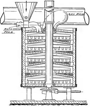
FIG. 25. HERRESHOFF PYRITES BURNER
