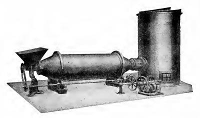
FIG. 22. ROTARY SULPHUR BURNER
