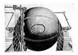
FIG. 5. SPHERICAL RAG BOILER
