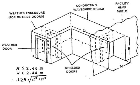
a. Waveguide entryway.
