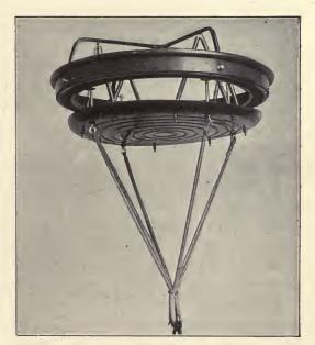
Fig. 110 .- Ballcon valves.
