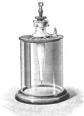
FIG. 37.—Wehnelt interrupter with single platinum anode (Siemens).
