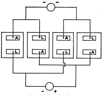
FIG. 15.-Aluminum cell rectifier.
