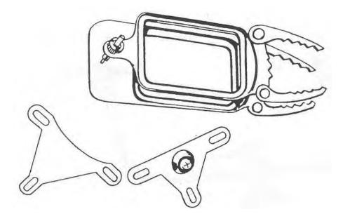
Figure 5-9. Needle point-tracer.
