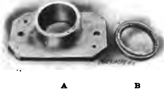
Fig. 13. Reverse Drawing Die
