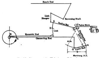
Fig. 26. Diagram of the Walschaerts Valve Gear
