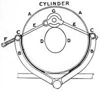
Fig. 18. SHOWING BRAKE USED ON MANN'S MACHINE.
