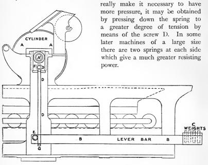
Fig. 16. SHOWING LEVER ARRANGEMENT IN FURNIVAL MACHINE FOR OBTAINING PRESSURE.
