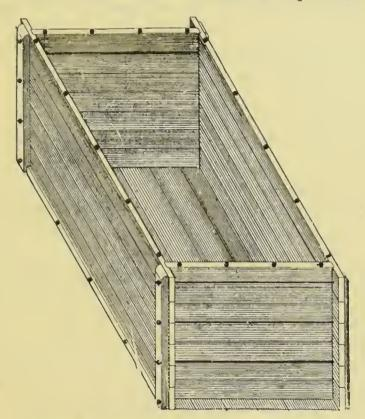
FIG. 12. SINGLE TANK FOR RETTING HEMP.
