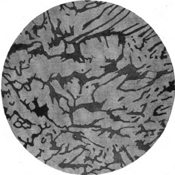
FIG. 229.—Structure of Muntz Metal. \times 230 .
