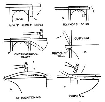
Fig. 24. Making bends over an anvil
