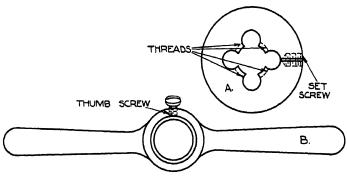
Fig. 45. Threading Dies
