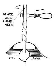
Fig. 23. Twisting a bar
