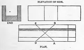
Fig. 50.—The Carpenter's Mitev Box.
