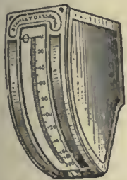
FIG. 4.—Edgewise Voltmeter. Stanley D'Arsonval type.
