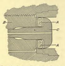
FIG. 36.-THE DE BANGE GAS STOPPER
