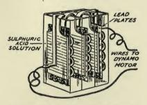
FIG. 35. A SIMPLE STORAGE BATTERY.
