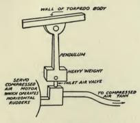
FIG. 41. THE PENDULUM CONTROL.
