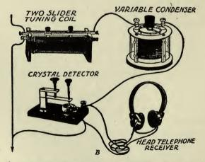
FIG. 56. A, THE TRANSMITTER READY TO SEND. B, THE RECEIVER READY TO LISTEN IN.
