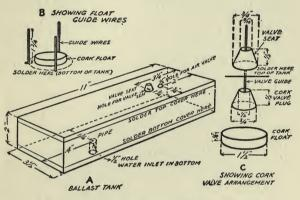
FIG. 14. HOW THE BALLAST TANK IS MADE.
