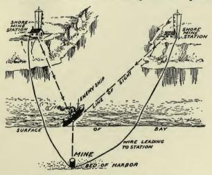
FIG. 50. HOW THE ELECTRIC MINE WORKS.
