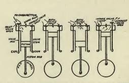
FIG. 31. HOW A FOUR-CYCLE GASOLINE ENGINE WORKS.
