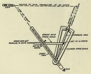
FIG. 44. HOW THE TORPEDO DIRECTOR WORKS.
