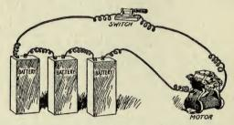
FIG. 16. HOW THE POWER PLANT IS CONNECTED UP.
