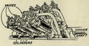
FIG. 30. EIGHT CYLINDER GASOLINE OR PETROL ENGINE.
