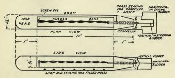
FIG. 36. A MODEL TORPEDO.
