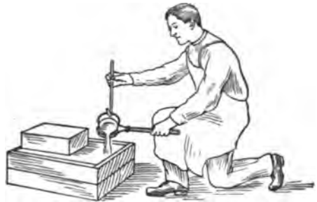
Fig. 4—Pouring the Metal
