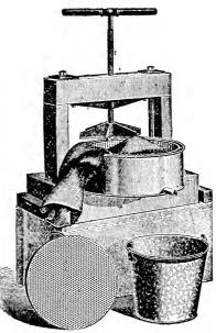
Fig. 13.—" HATCH " WAX PRESS.
