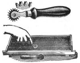
Fig. 91.-Wire Imbedder.
