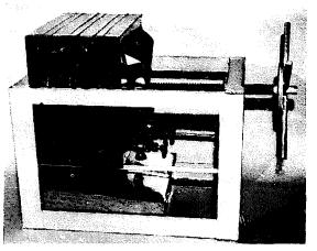
Fig. 1.-Small Filter Press.
