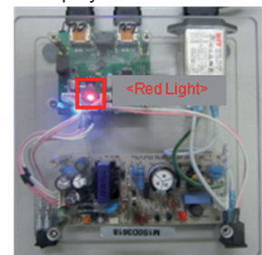
사진 2. MHL 검사 JIG (NG) Picture 2. MHL Function JIG (NG)
