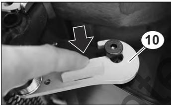
Fig. 62 Desbloquear la compuerta de la batería
