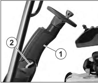
Fig. 17 Columna de dirección
