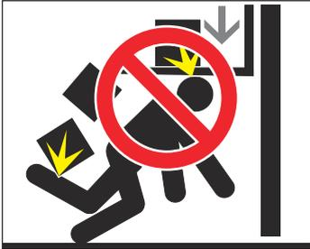
Existe riesgo de lesiones si se cae una carga o durante la elevación y el descenso de las horquillas.
