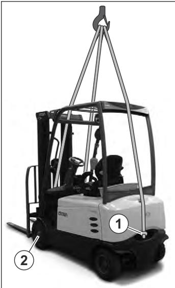
Fig. 66 Elevación de la carretilla con una grúa
