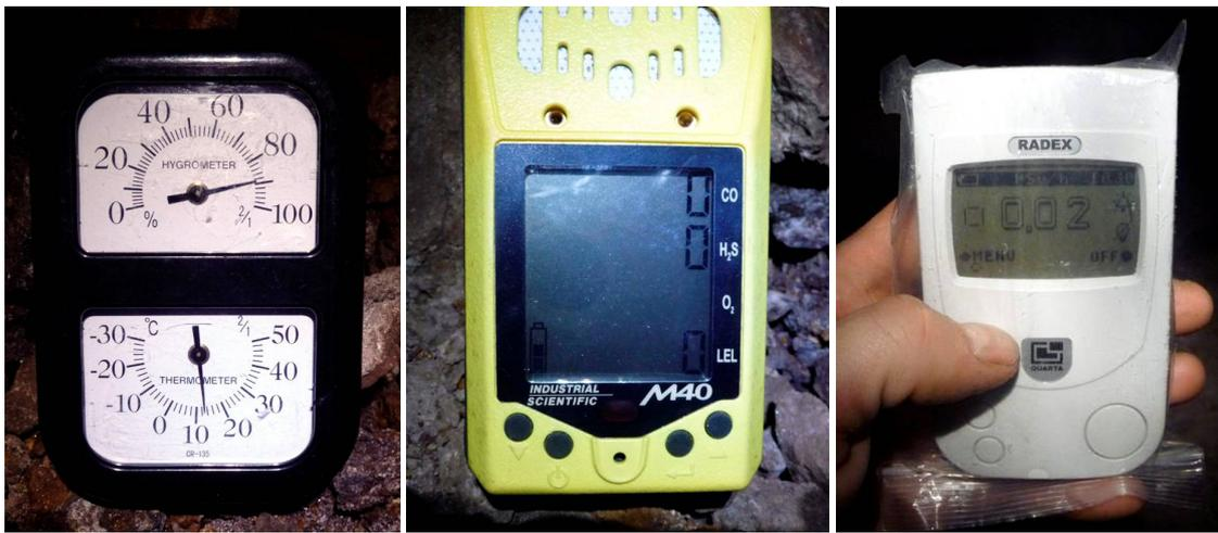
Paramètres type d'une mine de fer : humidité 90%, température 12°C, absence de monoxyde de carbone, absence de sulfure d'hydrogène, absence de gaz explosif, débit de dose<sup>47</sup> 0,02 micro Sievert par heure en fin de galerie.
