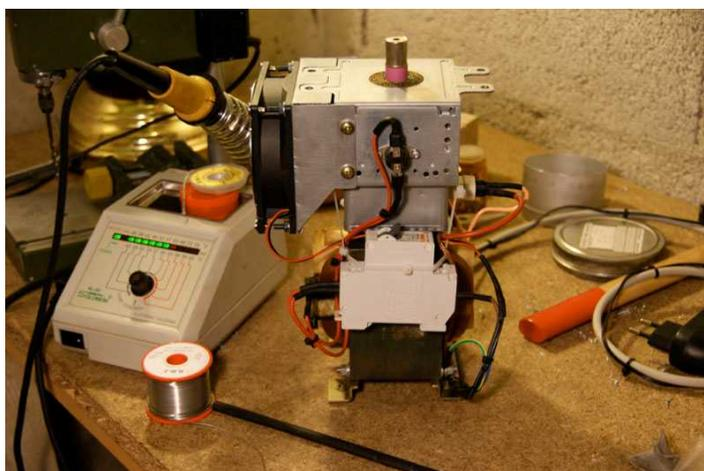
À gauche, le ventilateur de refroidissement du tube. Au milieu avec les fils rouges, la protection thermique et dessous le disjoncteur.
