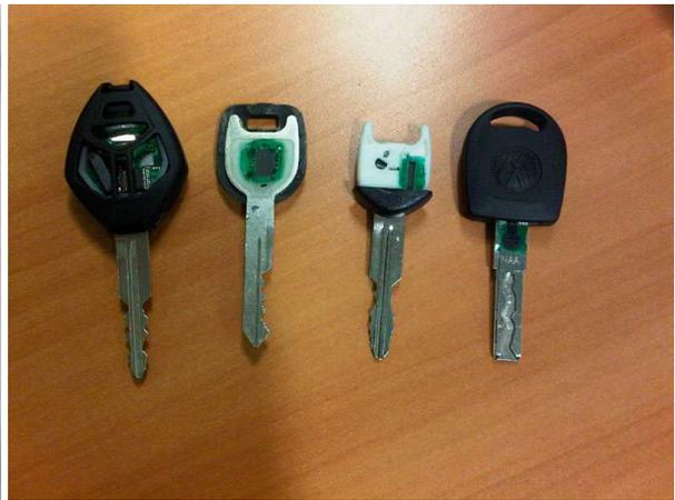
Transpondeurs pour anti-démarrage de véhicules
