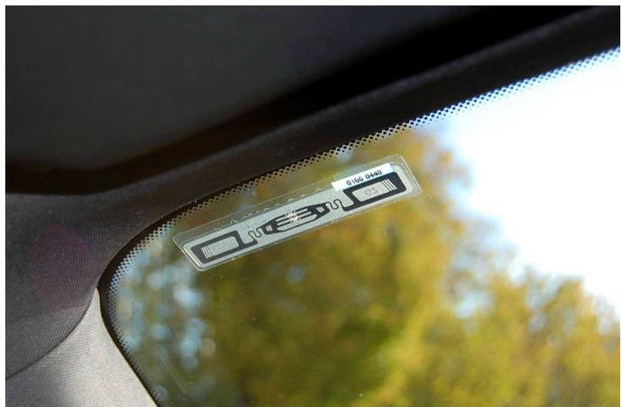
Transpondeur autocollant pour pare-brise
