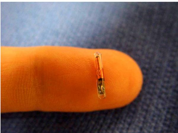
Transpondeur pour implant sous-cutané
