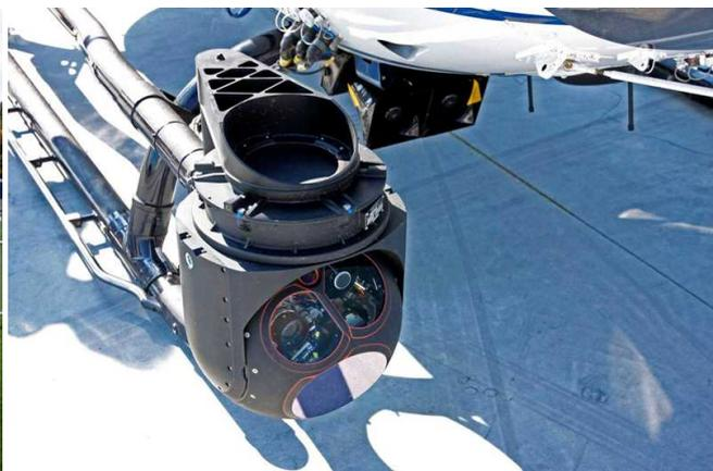
Pod gyrostabilisé montrant diverses optiques
