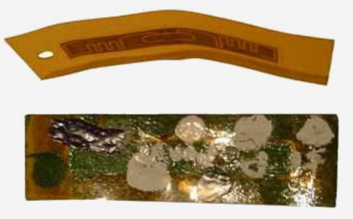
Transpondeur autocollant pour emballages métalliques
