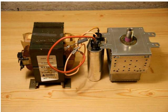
Le transformateur, le condensateur avec la diode et le magnétron
