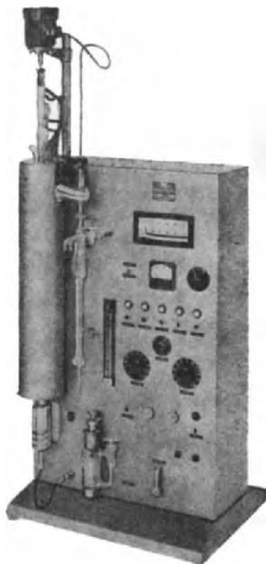
Fig. 282b) Spinning band column (Abegg)
