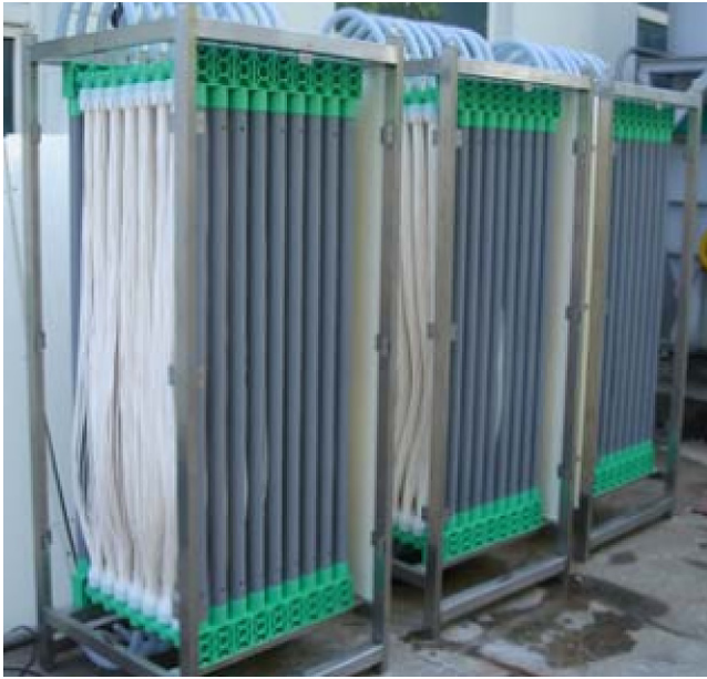
FIG. 4.43 The Philos MBR module.
