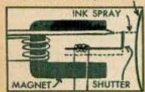
SCHEMATIC PLAN OF OPERATION OF THE MONITOR RECEIVER
