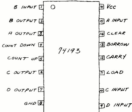
Fig. 4. 74193 pin diagram.
