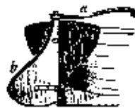
Rudder 3255-MN a Tiller; b Rudder
