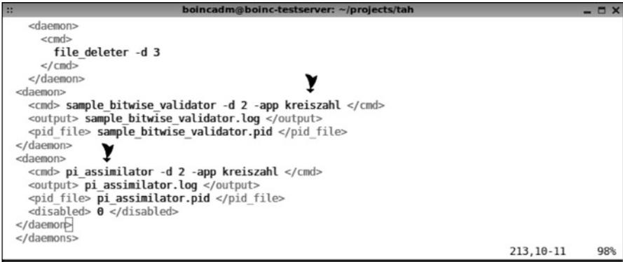
Abb. 11.6 Modifikation der Konfiguration config.xml für Kreiszahl@home. Die Dämonen werden für die Verarbeitung von Ergebnissen der wissenschaftlichen Applikation kreiszahl eingestellt. Zudem wird ein eigener Assimilierer pi\_assimilator konfiguriert
