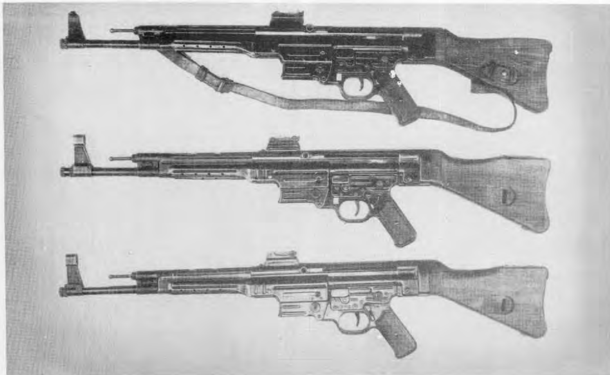
7.92 Submachine Gun: Top, M. P. 43; Center, M. P. 43/1; Bottom, M. P. 44
