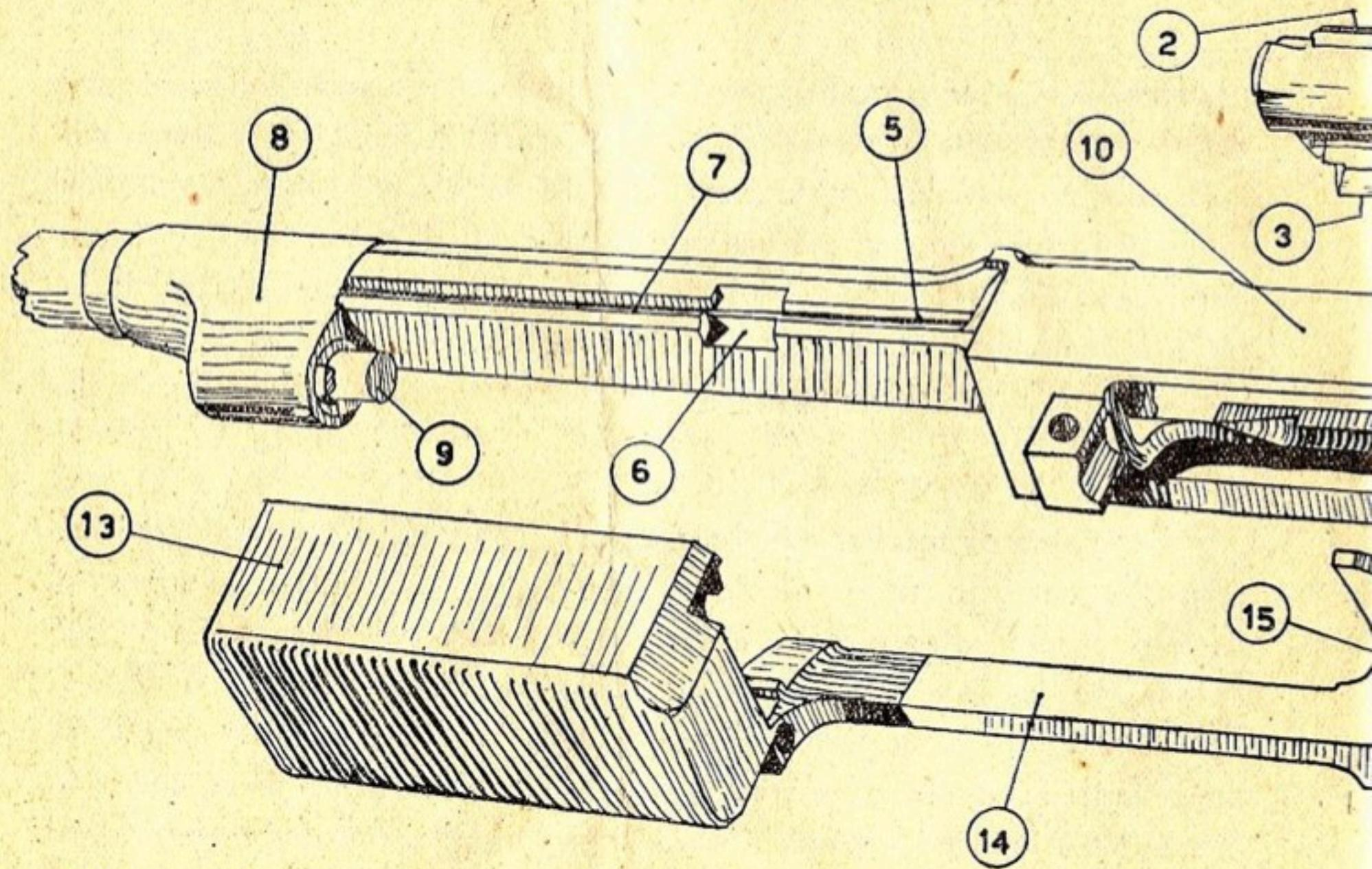
fig. 4 - otturatore, culatta, castello, carrello
