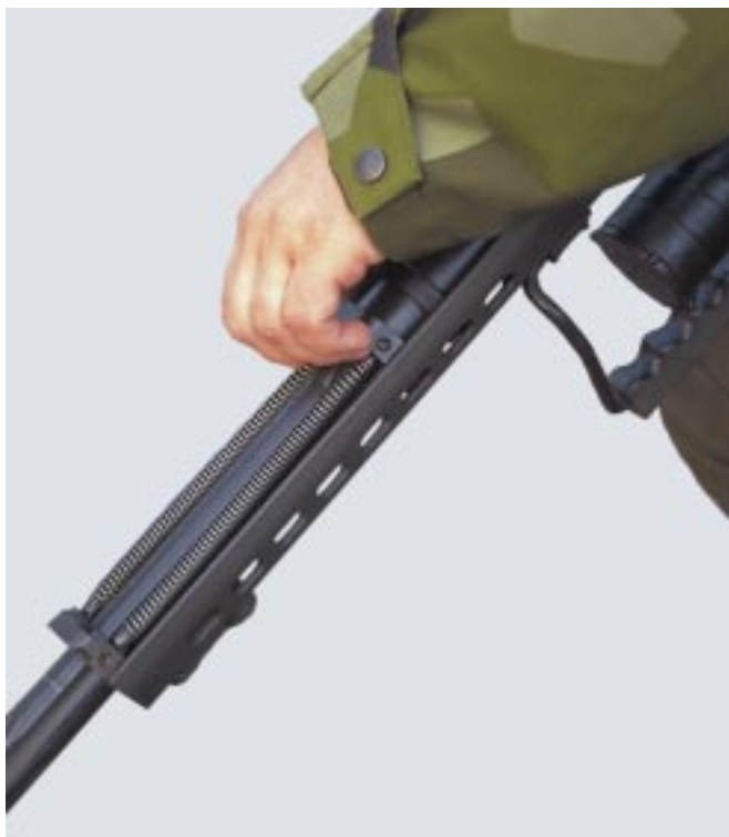
Manteln upp- och nervänd, låsbygeln pressas bakåt
