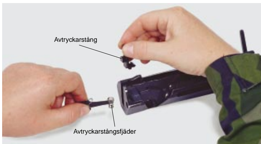
Avtryckarstångsfjäder och avtryckarstång monteras
