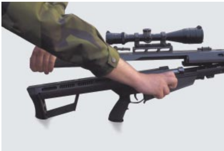
Manöverhandtaget dras bakåt och hålls kvar, manteln lyfts upp
