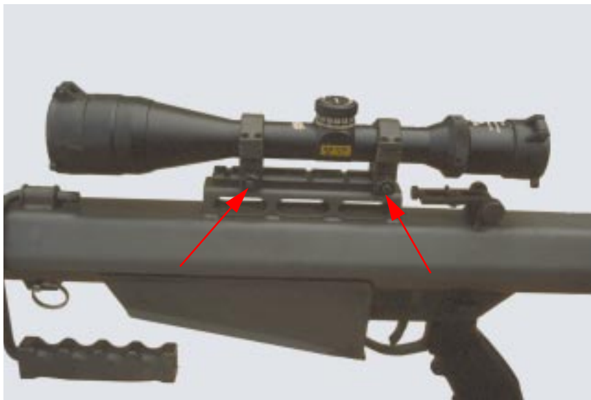
Borttagning av kikarsikte – muttrarna är markerade
