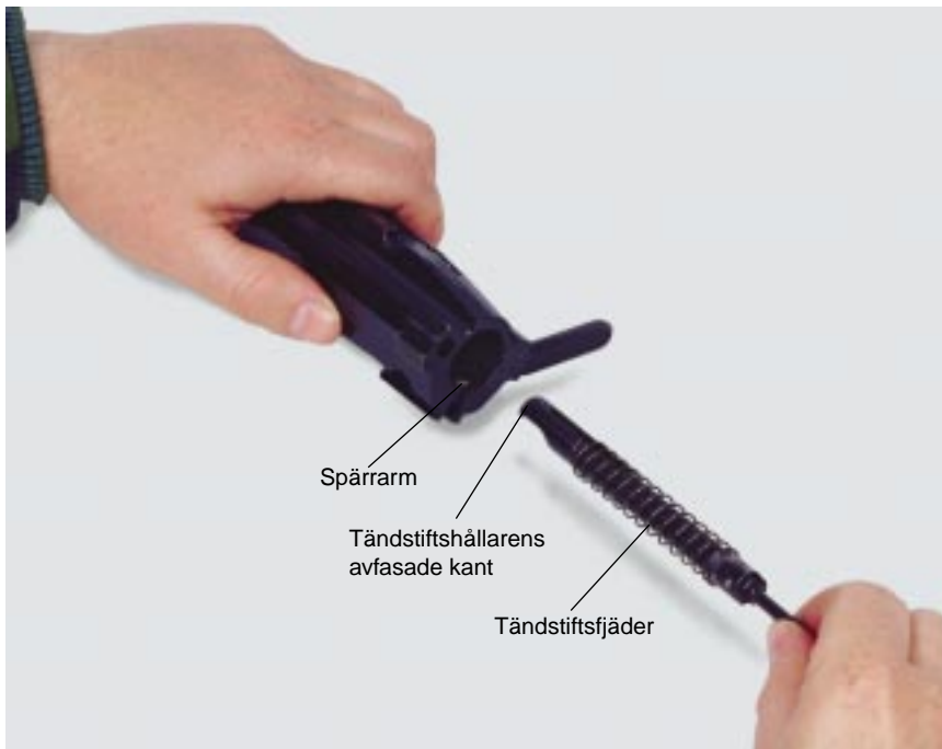
Tändstiftshållaren förs in med den avfasade kanten mot spärrarmen
