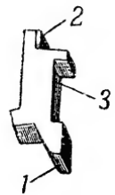
Рис. 20. Останов затвора: 1 — нижний выступ; 2 — верхний выступ; 3 — вырез.
