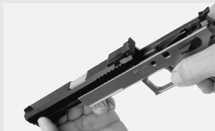
Fig. 3 Desprendimiento del corredera
