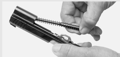
Fig. 4 Retirer le dispositif amortisseur
