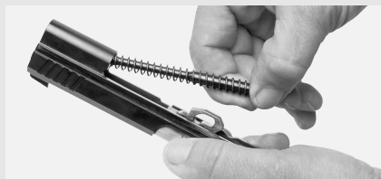
Fig. 4 Extracción del dispositivo amortiguador
