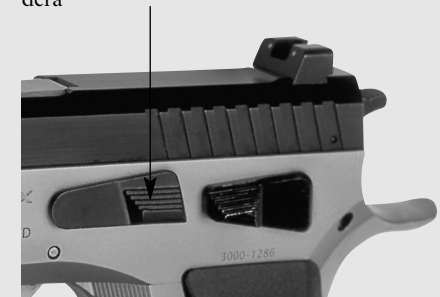
Presionar la palanca de retención de la corredera
