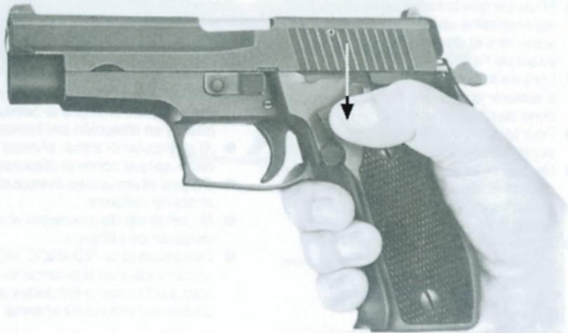
Dadurch wird der Schlaghebel gespannt und eine Patrone in das Rohr eingeführt.
