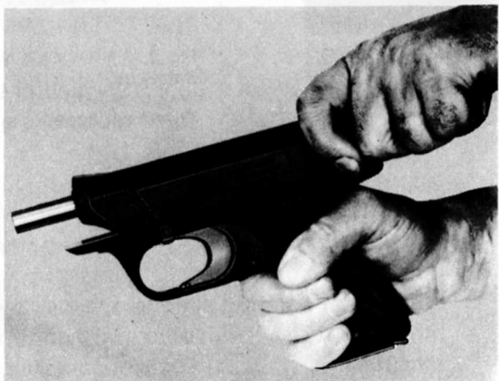
Fig. 4: Pull back the slide Retroceder la corredera Tirer le bloc-culasse vers l'arriere
