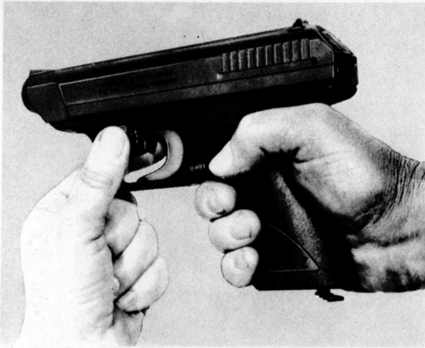
Fig. 6: Pull retaining catch downward Bajar palanca de montaje Tirer le verrou d'assemblage
